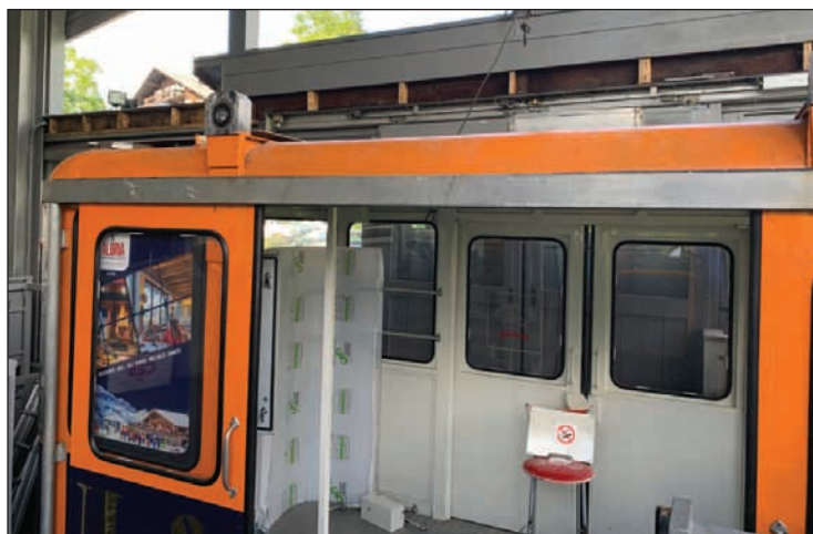
Una delle quattro cabine oggetto di revamping tecnologico: videosorveglianza di bordo per monitoraggio area passeggeri e via di corsa monte/valle, intercom IP e sistemi PLC
